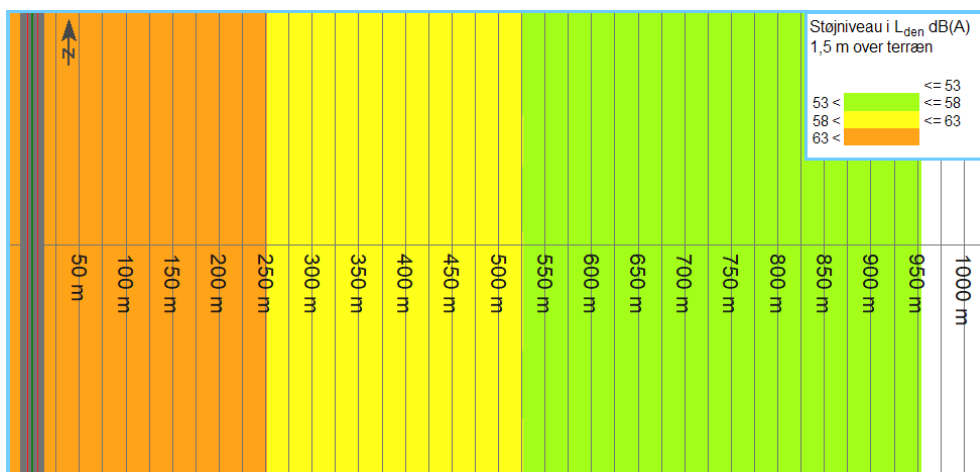
Figur 7: Motorvej med 130 km/t og 17.000 køretøjer pr. døgn.
