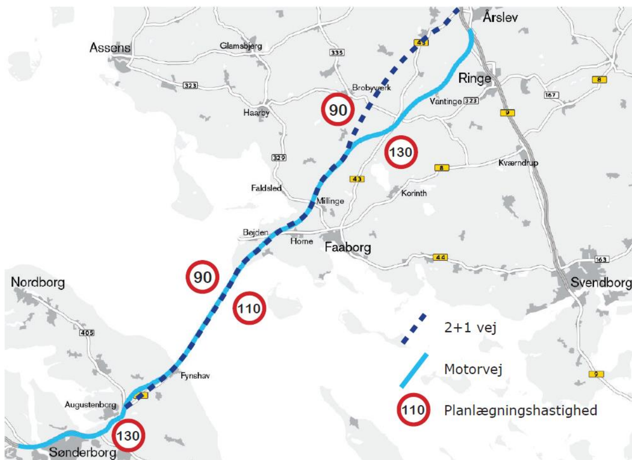
Figur 6: Forventede skilte hastigheder i motorvejsscenarioet (nedenfor linjeføring) og 2+1 løsningen (ovenfor linjeføring). Optegningen er helt indledende og på ingen måde en bindende skitsering af mulige korridorer for en fast vejforbindelse mellem Als og Fyn samt de tilhørende landanlæg. Baggrundskort: Vejdirektoratet.
