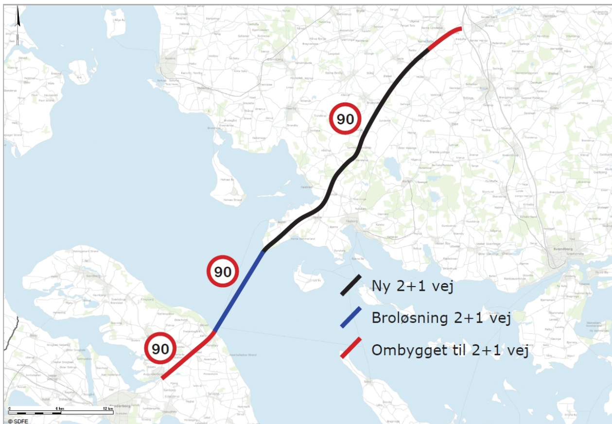
Figur 4-2: Omtrentlig linjeføring for 2+1 vej samt angivelse af nyt tracé (sort) og opgradering af eksisterende vej (rødt).
